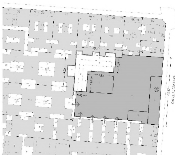
Figura 7: Mejora condiciones de iluminación y ventilación natural de patios vecinos
